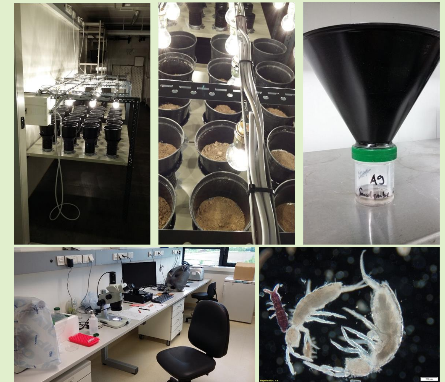
Abb. 1: Apparatur für die Extraktion der Mesofauna aus Bodenproben (Berlese Tullgren Funnel)
